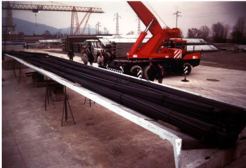
Fig. 15 Prova di carico su prototipo di grande elemento per copertura eseguita ai fini della messa a punto del progetto strutturale
