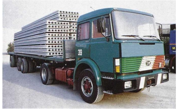
Fig. 9 Trasporto di pannelli alveolari per solaio
